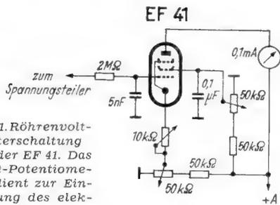
Bild 1. Röhrenvoltmeterschaltung mit der EF 41. Das 50-kΩ-Potentiometer dient zur Einstellung des elektrischen Nullpunktes
