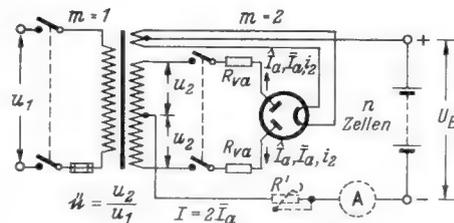
Prinzipschaltung eines Ladegerätes mit gasgefüllter Röhre
