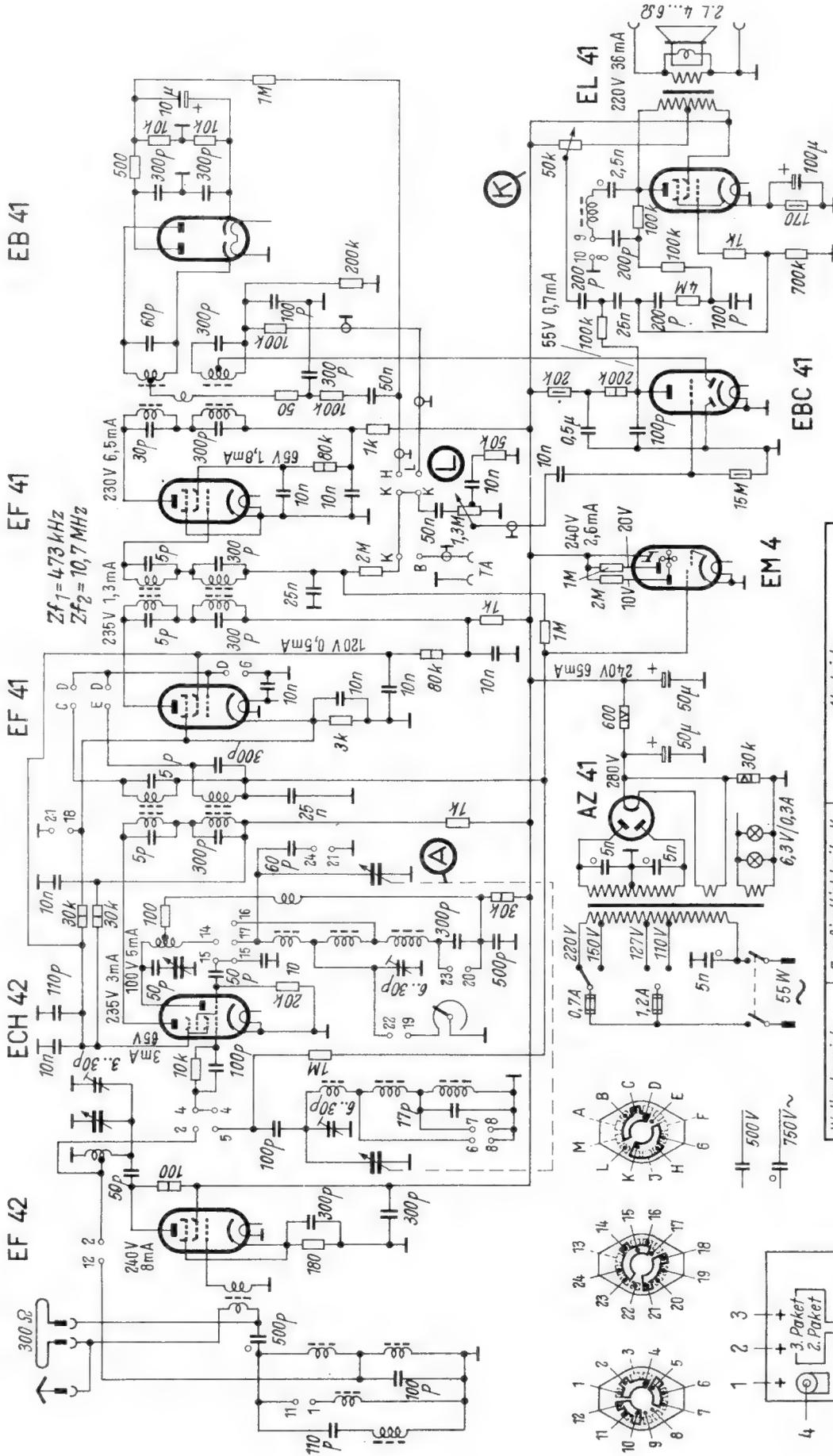
Sämtliche Spannungen und Ströme sind bei AM mit einem Instrument 333Ω/V im 300-V-Bereich gemessen.
