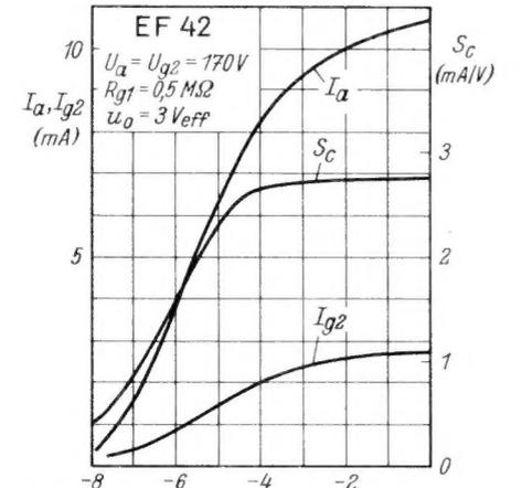
Bild 11. Abhängigkeit der Mischteilheit und der Elektrodenströme von einer Grundgitterspannung Ug1
