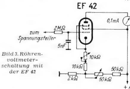
Bild 3. Röhrenvoltmeterschaltung mit der EF 42
