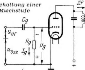
Bild 2. Wirkungsweise der additiven Mischung an der Kennlinie des Oszillatorsystems dargestellt
