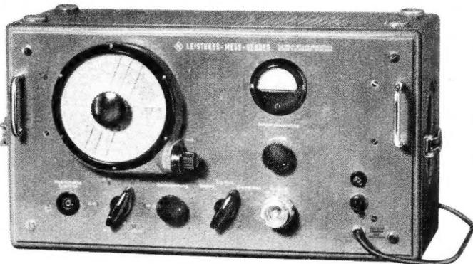
Das Gerät hat einen sechsfach unterteilten Frequenzbereich von 30 ... 300 MHz und ist in vielseitiger Weise als eigen- und fremdmodulierbarer Generator zur Speisung von Meßleitungen, zur Untersuchung von Netzwerken, zur Steuerung von Verstärkern, als Überlagerer und zum Gleichlaufabgleich von Empfängern verwendbar. Die genaue Einstellbarkeit kleiner definierter Frequenzänderungen ermöglicht Gütemessungen bis zu Kreisgüten über 1000.
