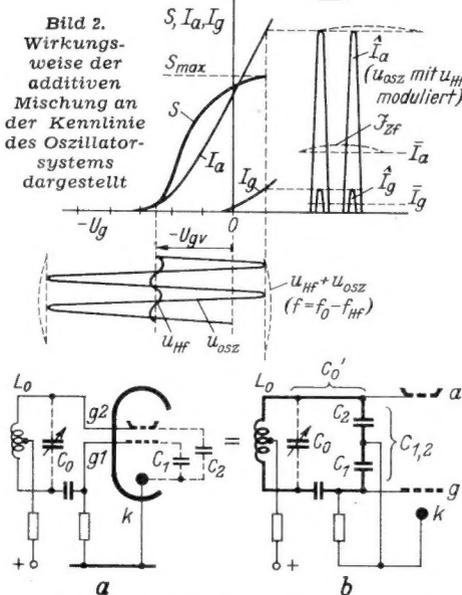
Bild 3. Oszillatorteil einer selbstoszillierenden Pentodenmischstufe
