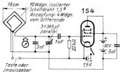
Unten: Bild 2. Schaltbild des Superhetempfängers. Sender und Empfänger machen je von einer Rahmenantenne Gebrauch
