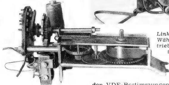
Ein auf Amplitudenänderungen ansprechendes System ist ähnlich aufgebaut: das veränderliche Glied des Senders ist ein Regelwiderstand, während auf der Empfangsseite ein gleicher Regelwiderstand durch eine amplitudenvergleichende Schaltung mitgedreht wird.
