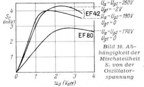
Bild 10. Abhängigkeit der Mischteilheit Sc von der Oszillatortension
