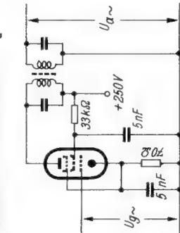
Die 6 BA 6 als Zf-Verstärker für 10,7 MHz. Q = 70, bZf = 200 kHz; U<sub>b</sub> = 250 Volt, V = 44
