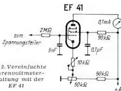
Bild 2. Vereinfachte Röhrenvoltmeterschaltung mit der EF 41
