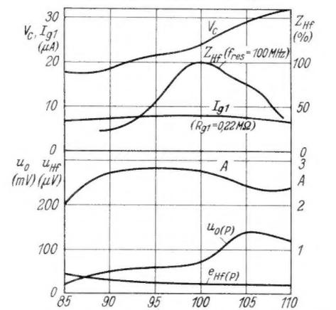
Bild 12. Abhängigkeit der Mischverstärkung Vc, der Aufschaukelung A durch die Antennenkopplung, der Oszillatortension uo im Punkt P und der nutzbaren Hf-Eingangsspannung (Grenzempfindlichkeit für Störabstand 1:5) im Punkt P (e<sub>Hf</sub>) von der Abstimmfrequenz des Hf-Kreises, gemessen mit der Schaltung nach Bild 8 (EF 42). Außerdem ist die Resonanzkurve des Hf-Kreises für eine Abstimmfrequenz von 100 MHz eingezeichnet (ZHf)
