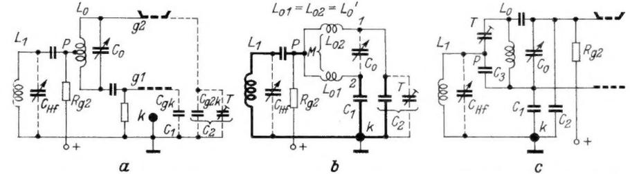
Bild 5. Oszillator- und Hf-Kreis der selbstoszillierenden Pentodenmischstufe. a) Prinzipschaltung mit Einkopplung der Hf-Spannung an der Oszillatortspule, b) Ersatzschaltung für den Hf-Kreis, c) Kapazitive Einkopplung
